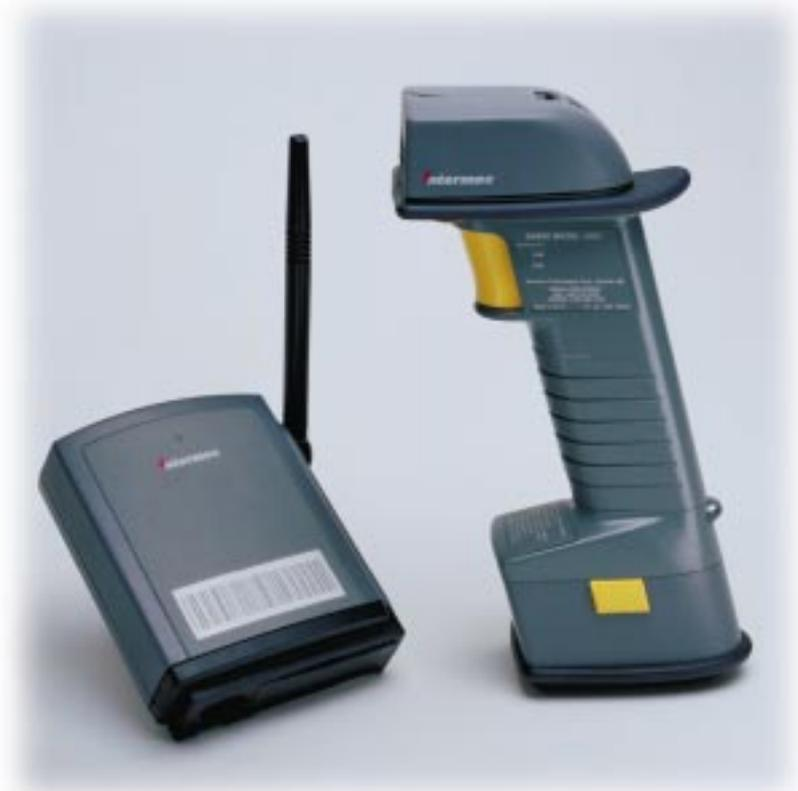
Der schnurlose Scanner Sabre 1552 liefert eine unvergleichbare Flexibilität beim Scannen von Barcodes. Jobs gestalten sich einfacher, weil kein Kabel beschädigt oder verdreht werden kann. Sie können den Sabre 1552 mit zu Ihrem Job nehmen – bis zu 15 m von der Basisstation 9745 entfernt.
